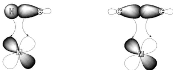
Abbildung 1. Schematische Darstellung der R-H- (links) und der R-R-Bindungsspaltung (rechts), die den Einfluß der C-C- und der C-H-Orbitalausrichtung auf den oxidativen Additionsprozeß verdeutlicht.
